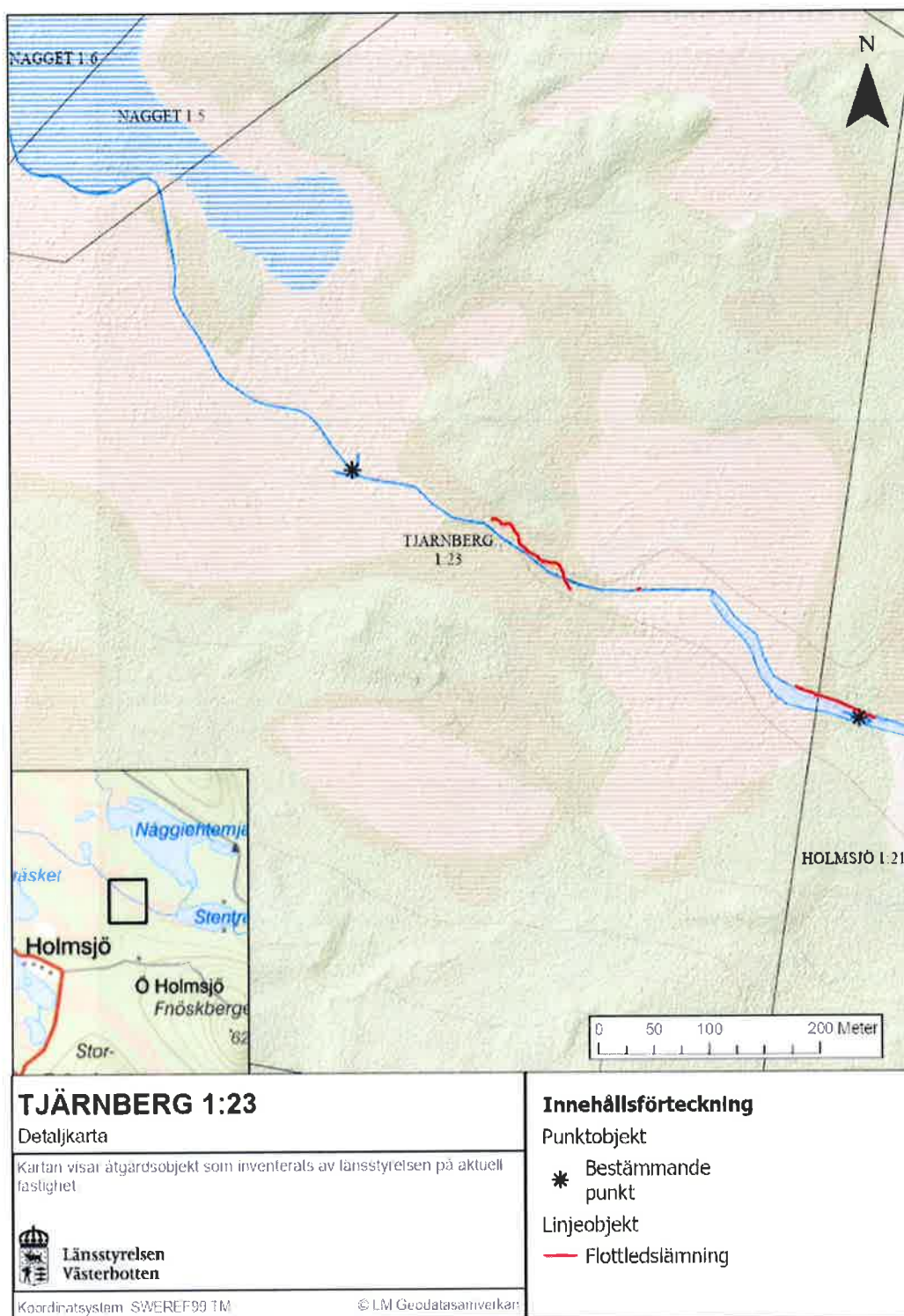
Karta 3. Detaljkarta över det inventerade återställningsbehovet samt planerade åtgärdssträckor i Verbobäcken som finns inom fastighet TJÄRNBERG 1:23. Här återfinns flottledslämningar i form av ett par partier med sporadiska rensningar längs med vattnet. Sten- och blockmassorna från dessa lämningar planeras att återbördas till vattendraget för att kunna återskapa naturliga habitat och processer. I tillägg finns även en bestämmande punkt längs med sträckan som kan komma att förstärkas, för att således kunna bidra till höjd basnivån på vattendraget.
